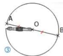
On trace le cercle de centre O et de diamètre [AB] avec le compas.
